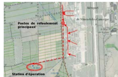
Architecture du réseau eaux usées
